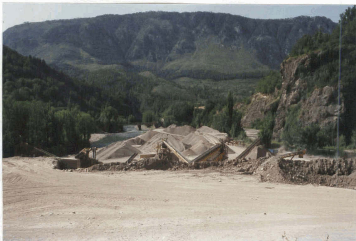
Fotografía 11.- Impacto visual de los acopios de la ficha 33-11-3-2. Contraste de color y situación junto a carretera.
